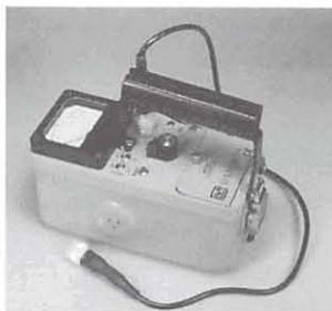
Compteur portable (utilisé avec une sonde de scintillation [qui n'est pas montrée] ou sonde GM type «poêle à frire»
