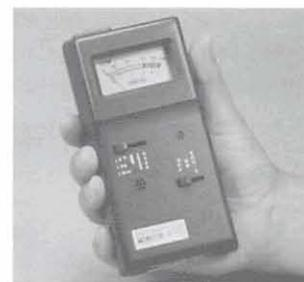
Compteur portable (il mesure les rayonnements alpha, bêta et gamma)
