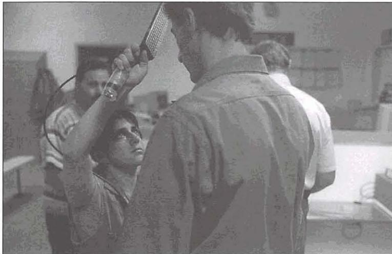
Un travailleur de l'usine de plutonium de Hanford dans l'Etat de Washington est soumis à un contrôle de l'organisme entier en vue de détecter une possible contamination radioactive.
